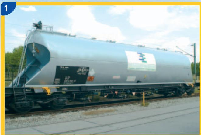
Silobahnwaggon mit 60-90 m<sup>3</sup> Fassungsvermögen für Gefahrgüter zugelassen. In einem solchen Waggon werden Elektro-Filteraschen aus Müllverbrennungsanlagen transportiert.
