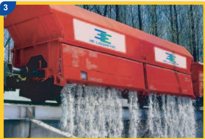
Diese Schlacken Bahnwaggons werden für den Transport von Müllverbrennungsschlacken eingesetzt. Wobei die Beladung mittels Schwerkraft und die Entladung mittels Kippvorgang oder Schwerkraft möglich ist.
