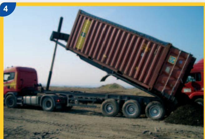
Diese in 20 oder auch 30 Fuss-Ausführungen verfügbaren Open Top Container werden für kontaminierte Böden eingesetzt, wobei die Entladung mittels Kipp-Chassis auf der Deponie vorgenommen wird.
