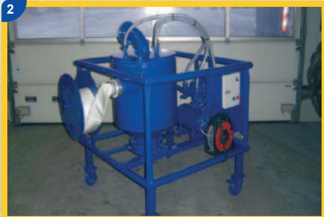
Dieser Spezial gebaute Adapter wird benötigt, um vom Silo LKW im geschlossenen System in einen Silobahnwagen (1) umzuschlagen. Der Adapter filtriert die Abluft mittels einer speziellen Filteranlage.
